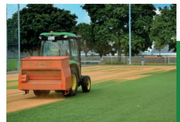
**Ihre Vorteile:** Verlängerung der Nutzungsdauer; Aufrichten der Fasern (soweit möglich); Messung des Verfüllmaterials; Entfernung von Unkraut, Algen, Moos; Wiederherstellung der Drainagewirkung; wesentliche Minderung des Granulataustrags durch „Wieder-Einbürsten“; Erstellen von Wartungsplänen; Zertifiziert nach RAL-GZ 944/6.
